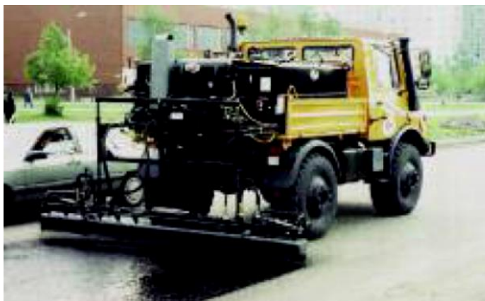
Kõrval: Eelmise kihi puhas ja korralikult krunditud pind tagab hea kihtidevahelise nakkumise
