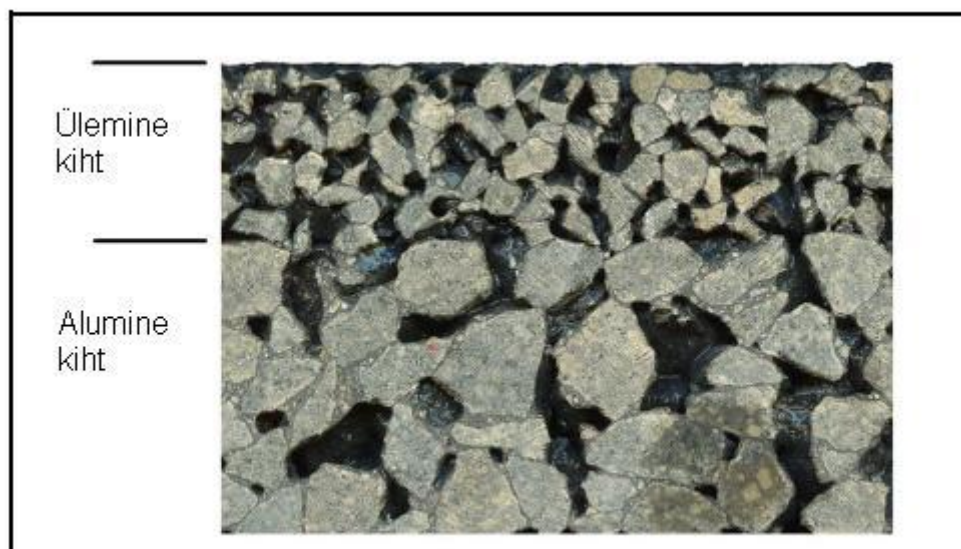
Joonis 7: Kahekihilise drenasfaldi (2L-PA) struktuur.
